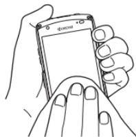
**2 Крепко обхватите устройство и встряхните его в направлении стрелок, пока вся вода не выйдет (со стороны микрофона системы шумоподавления: не менее 20 раз в каждом направлении, со стороны динамика/микрофона: не менее 20 раз в каждом направлении)**
